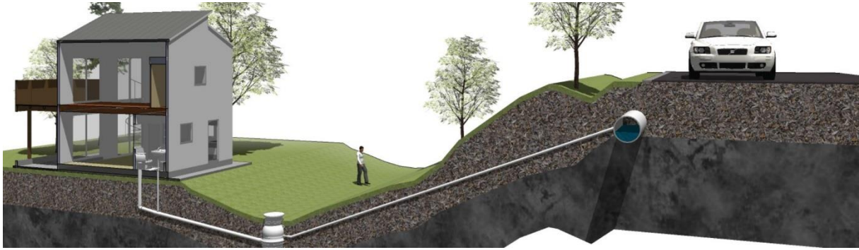
Figur 14. Illustration av LTA-system (från www.Tyreso.se).
