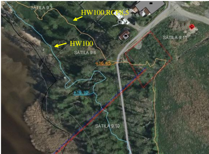
Figur 2. Blåsås. Beräknad högsta vattennivå 100-årsflöden HW100, markerad med ljusblå linje samt framtida nivå HW100, RCP8,5. Röd och blå linje markerar ungefärligt läge för vatten- och spillvattenledningar som förläggs med styrd borrning.
