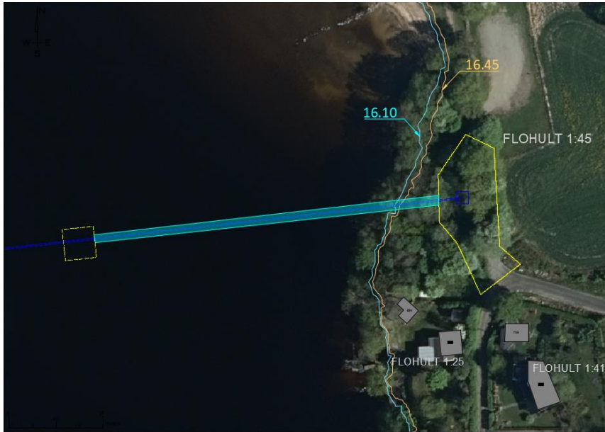
Figur 5. Arbetsområde i Flohult. Områden för permanent och tillfälligt ianspråktagande. Arbetsområden på land och ungefärligt område i vattnet har markerats med gul linje. Plats för ventilbrunn är markerad med blått.
